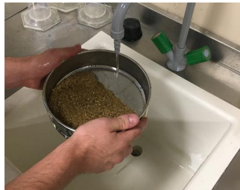
(d) Wet sieve analysis by washing
